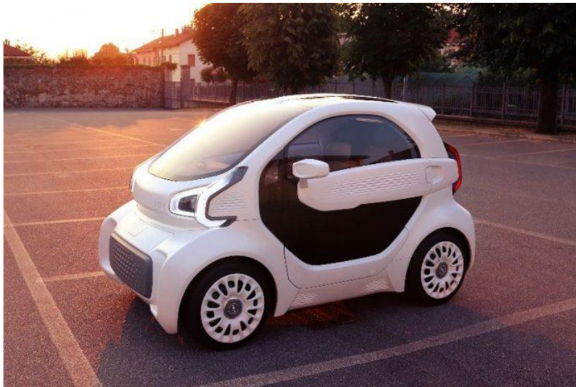
Figura 1-1: LSEV veículo elétrico fabricado em impressão 3D [6]
