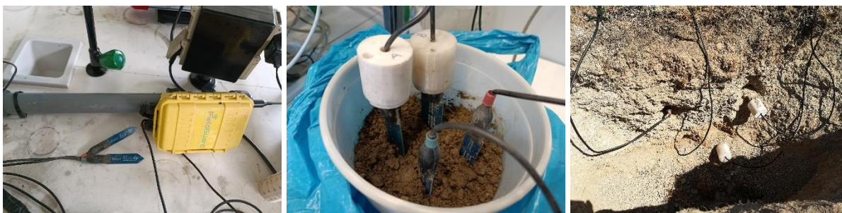
Figura 8: Sensores de determinação de humidade do solo.
