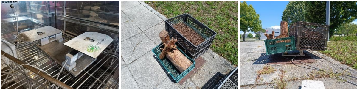
Figura 6: Balança com as duas células de carga e os combustíveis finos e combustíveis médios utilizados para a determinação do TH.
