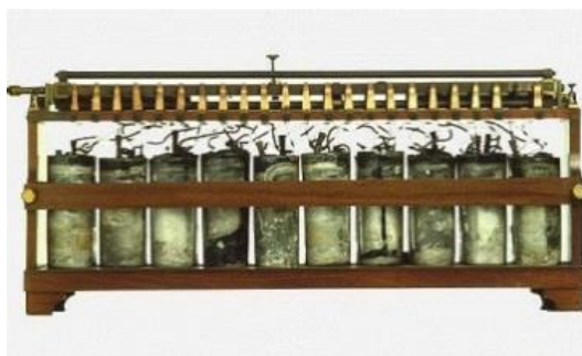
Figura 3-4: Primeira bateria de Chumbo ácido, a primeira bateria recarregável de Gaston Planté [11].
