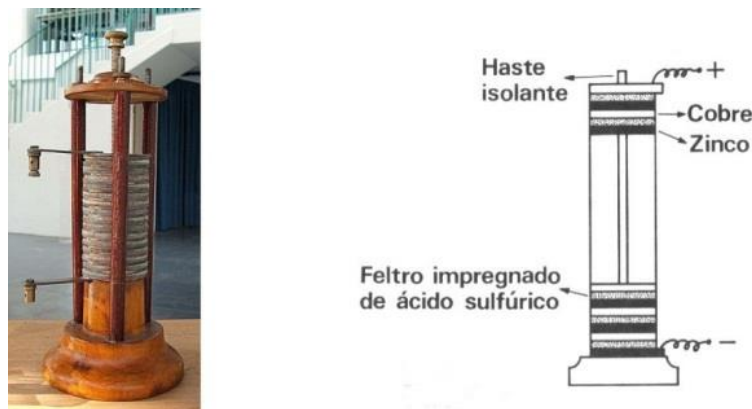
Figura 3-2: Bateria de Volta [9].
