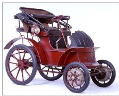
Figura 3-12: Veículo de Ferdinand Porsche que usava dois motores eléctricos, um em cada roda dianteira [17].
