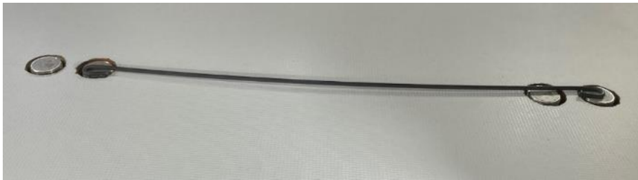
Figura 39-Arame 300mm colocado corretamente
