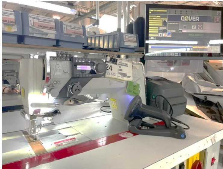
Figura 22-Poka Yoke adaptado a máquina de costura
