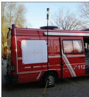
Fot. 4 - Suporte para terminal com a função Repeater (feuerwehr-parkstetten, 2016).
