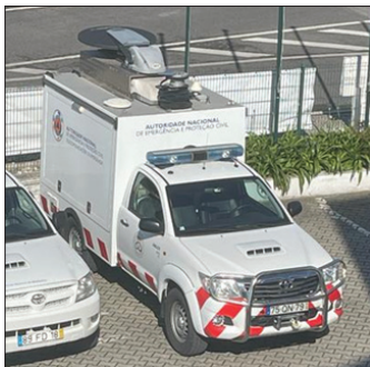
Fot. 2- Estação Móvel SIRESP, ligeira (Fotografia de Márcio Teles, tirada a 24/05/2023).
