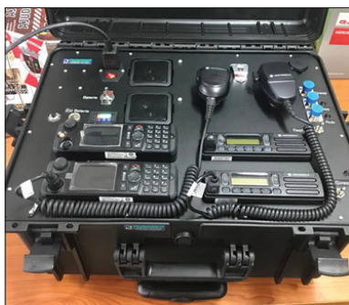
Fot. 5 - Equipamento portátil de Comunicações, SIRESP e banda alta VHF (Fotografia de Márcio Teles, tirada a 04/12/2023).
