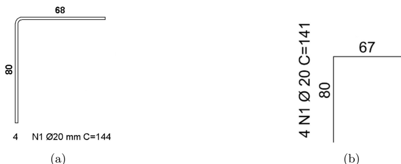
Figura 4.12: Detalhe do tirante da consola C02: (a) Armadura no Revit a partir do script desenvolvido em Dynamo; (b) Armadura em CAD (conforme o projeto de estudo de implantação BIM cedido por empresa).
