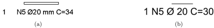
Figura 4.13: Detalhe da barra soldada na extremidade da consola C02: (a) Armadura no Revit a partir do script desenvolvido em Dynamo; (b) Armadura em CAD pela empresa.
