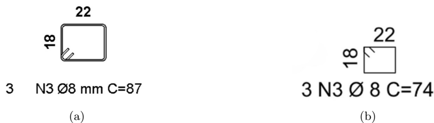
Figura 4.9: Detalhe da armadura transversal da consola C01: (a) Armadura no Revit a partir do script desenvolvido em Dynamo; (b) Armadura em CAD (conforme projeto de estudo de implantação BIM cedido por empresa).
