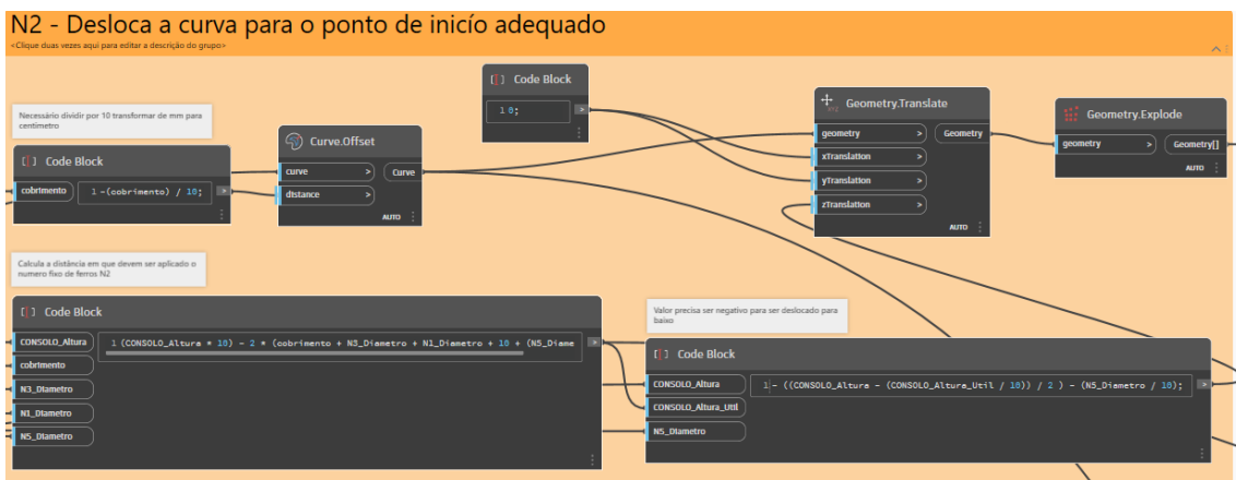
Figura 3.26: Ajuste das dimensões da curva base para a criação da armadura de costura. 1
