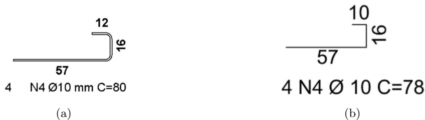
Figura 4.14: Detalhe da barra complementar da consola C02: (a) Armadura no Revit a partir do script desenvolvido em Dynamo; (b) Armadura em CAD pela empresa.
