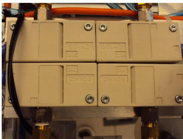
Figura 4-6 - Geradores de Vácuo
