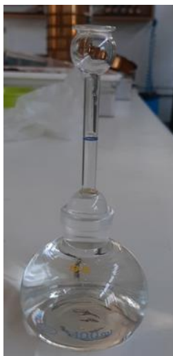
Figura 3-12: Picnómetro cheio com água destilada
