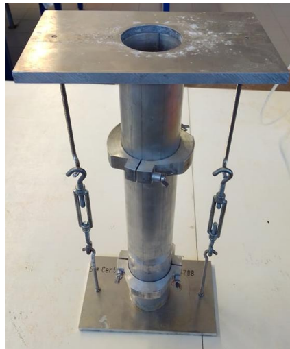
Figura 4-11: Mecanismo inicial para reconstituição de provetes
