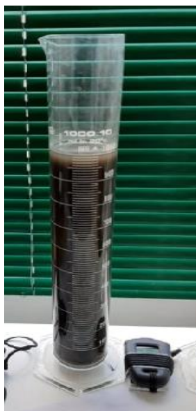
Figura 3-8: Aspeto do solo durante a execução do ensaio de sedimentação
