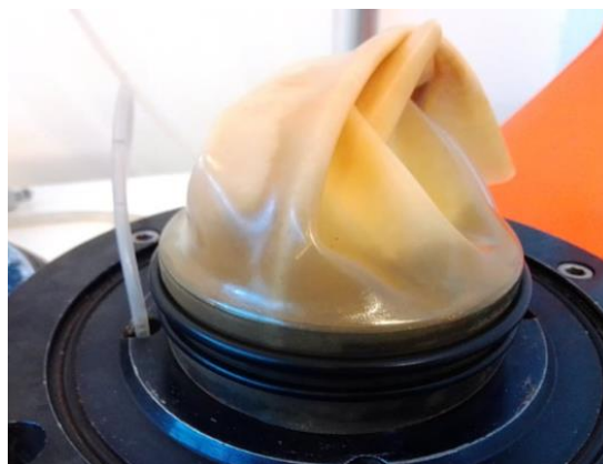
Figura 4-3: Fixação da membrana recorrendo a dois o-rings
