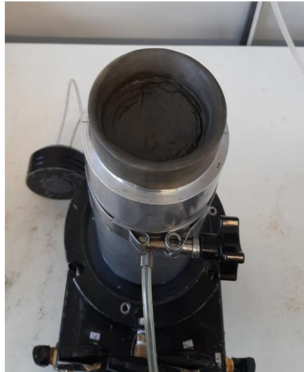
Figura 4-18: Remoção dos excessos de material sedimentado e regularização do topo do provete
