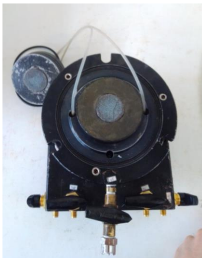
Figura 5-10: Representação do diâmetro das pedras porosas na base e topo do pedestal
