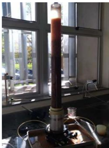
Figura 4-10: Sedimentação dos rejeitados para a reconstituição de provetes segundo Corrêa (2018)
