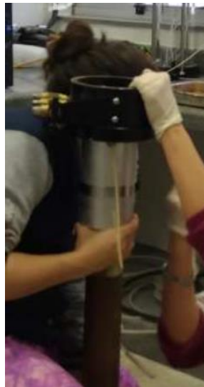
Figura 4-9: Montagem do método de reconstituição de amostras segundo Corrêa (2018)
