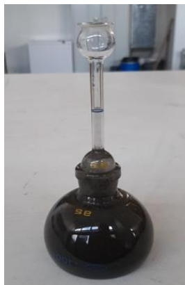
Figura 3-15: Equipamento cheio com água destilada pronto a pesar
