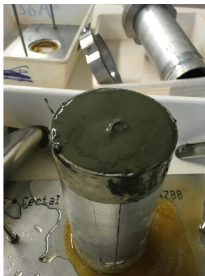
Figura 4-12: Aspeto final do material resultante da primeira tentativa de reconstituição de provetes
