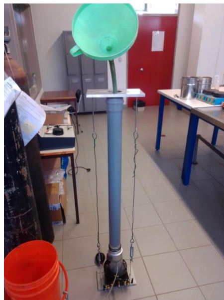
Figura 4-14: Colocação da mangueira e de um funil para depositar os rejeitados
