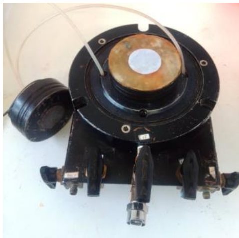
Figura 4-2: Aplicação dos dois discos de látex e o papel de filtro
