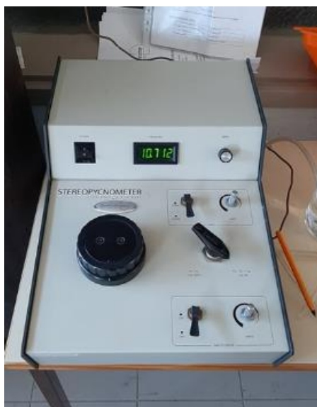
Figura 3-16: Representação do picnómetro com hélio
