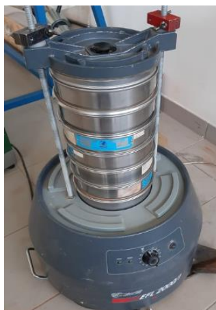
Figura 3-5: Realização do ensaio de peneiração recorrendo à peneiração mecânica
