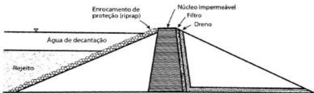
Figura 2-6: Barragem convencional em aterro compactado (adaptado de EPA, 1994)
