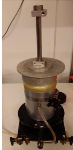
Figura 4-4: Compactação das diferentes camadas utilizando um compactador
