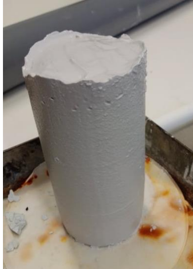
Figura 4-15: Aspeto do provete resultante da segunda tentativa de reconstituição
