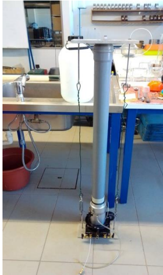
Figura 4-16: Preparação do método final de reconstituição de provetes
