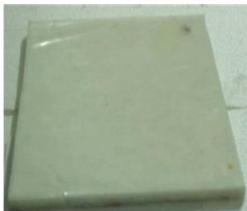
Figura 3-8 Exemplo de PCM de forma estabilizada (Zhou, et al. , 2012).
