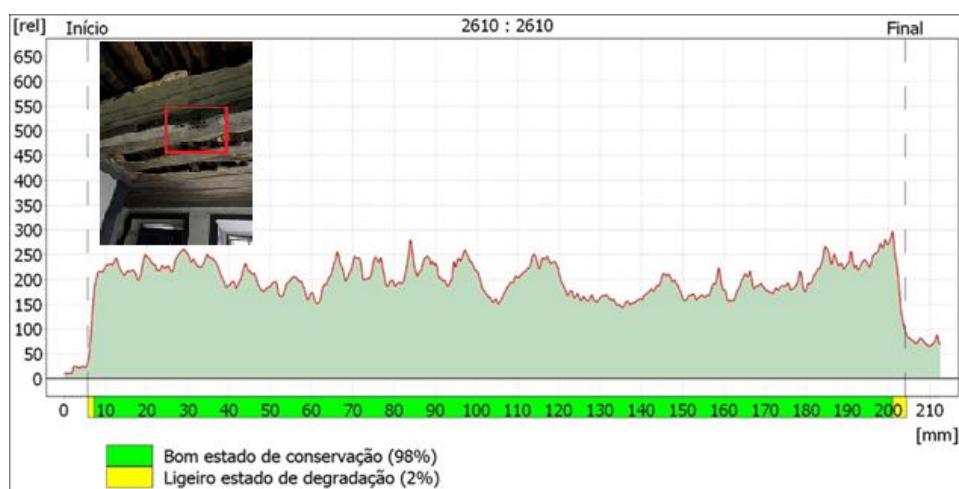
Figura 93: Pav.2 - R.PAV.1.2 (b=10cm; h=20cm) - Valor médio = 203
