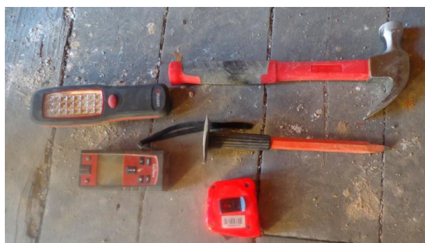
Figura 33: Materiais utilizados para a abertura das janelas de inspeção nas PT
