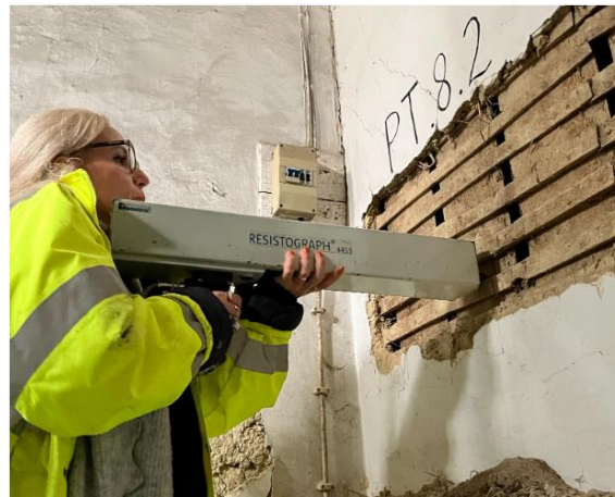
Figura 79: Realização do ensaio com Resistograph® em paredes de tabique
