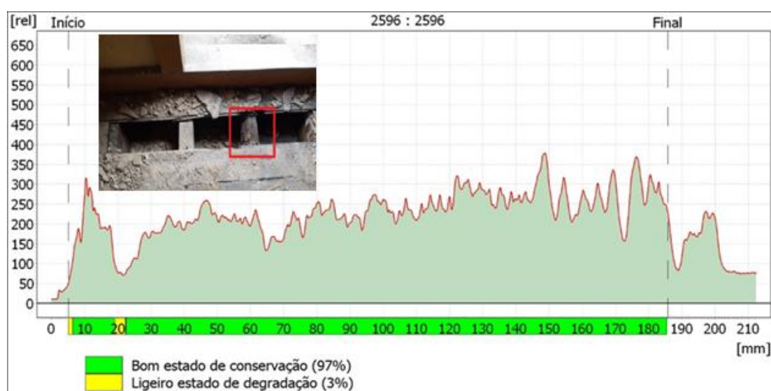
Figura 95: Pav.3 – R.PAV.3.3 (b=7,5cm; h=18cm) - Valor médio = 229
