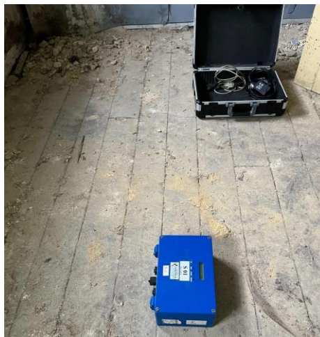
Figura 73: Utilização de sismógrafo na identificação dinâmica de um pavimento de madeira
