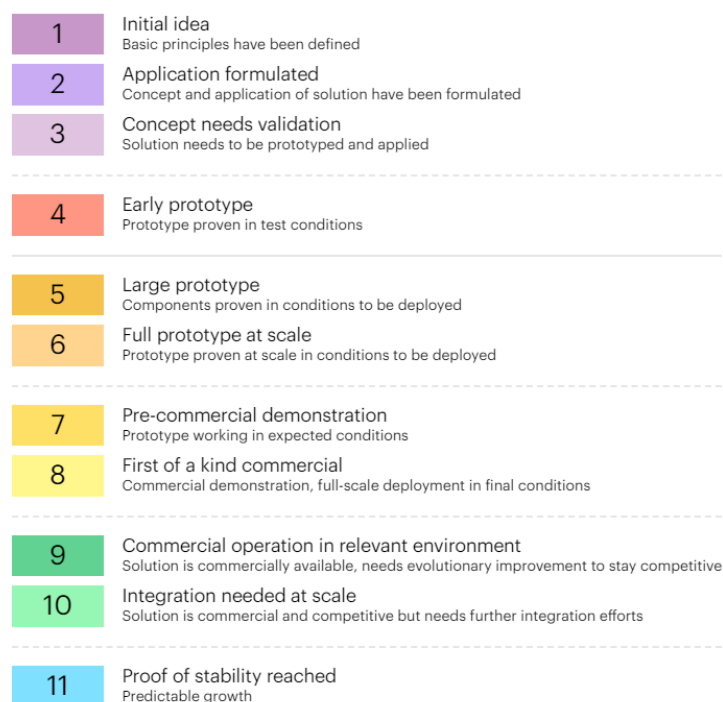
Figura 20 – Escala TRL adotada pela AIE
