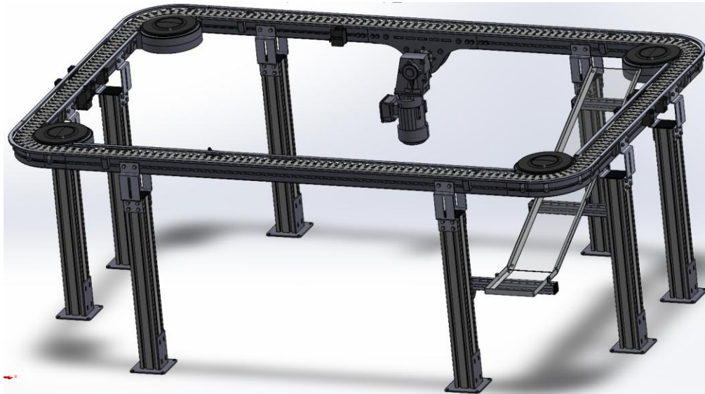
Figura 35 – Representação do transportador da CFF.
