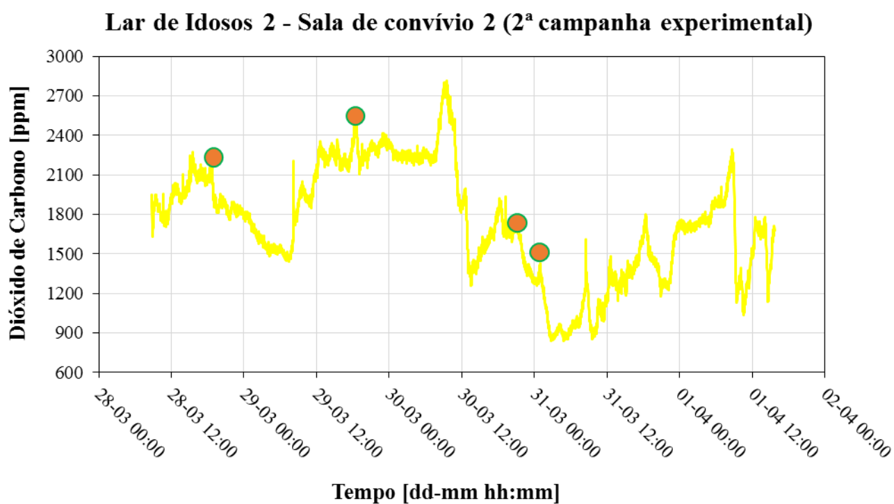
Gráfico X-40: Evolução de CO 2 registado na sala de convívio 2 do lar de idosos 2, com os pontos iniciais do decaimento devidamente identificados – 2ª campanha experimental
