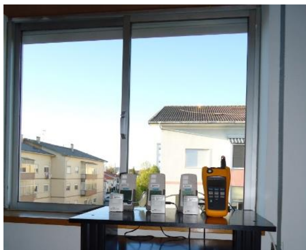
Figura 3-9: Ensaio in situ realizado com os equipamentos Telaire e Fluke, junto a um vão envidraçado
