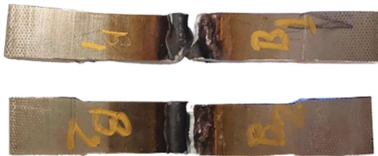
Figura 66 - Provetes B1 e B2, após ensaio de tração.
