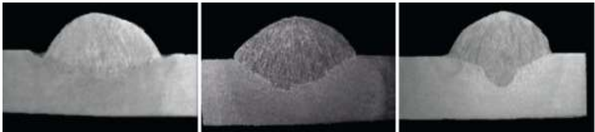
Figura 14 - Secções transversais de soldadura para as diferentes posições da tocha “forehand” (esquerda), perpendicular (centro) e “backhand” (direita). [19]
