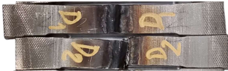
Figura 70 - Provetes D1 e D2, após ensaio de tração.
