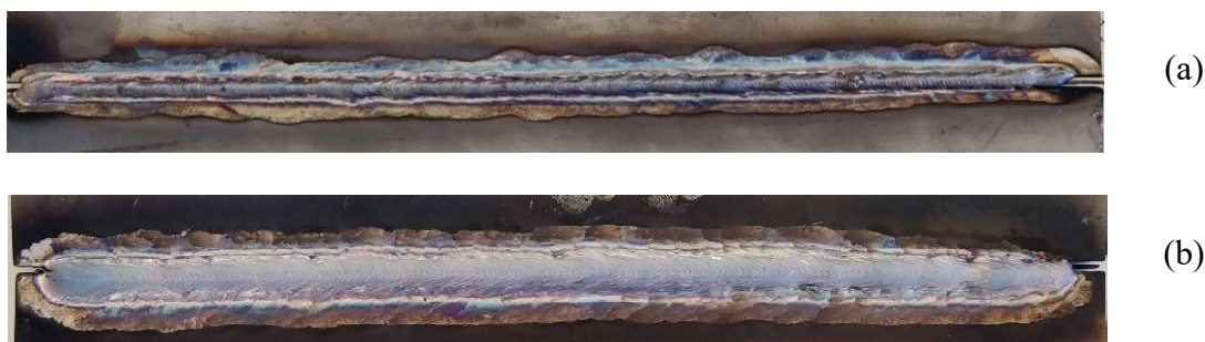
Figura 37 - Cordão de soldadura da Amostra A. Arco não pulsado (a) e Arco Pulsado (b).
