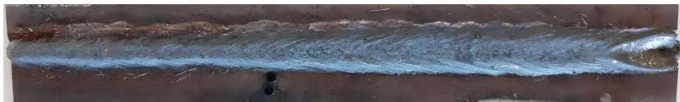
Figura 54 - Cordão de soldadura da amostra K.
