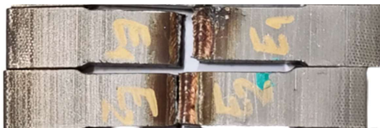
Figura 72 - Provetes E1 e E2, após ensaio de tração.
