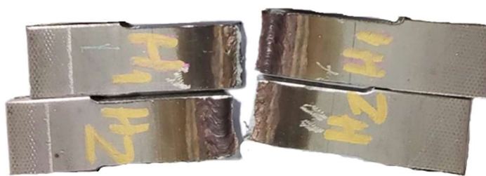
Figura 78 - Provetes H1 e H2, após ensaio de tração.
