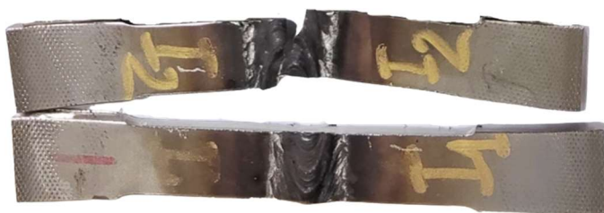
Figura 80 - Provetes I1 e I2 após ensaio de tração.
