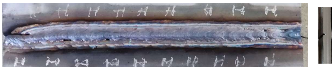
Figura 49 - Cordão de soldadura e secção transversal do provete da amostra H.
