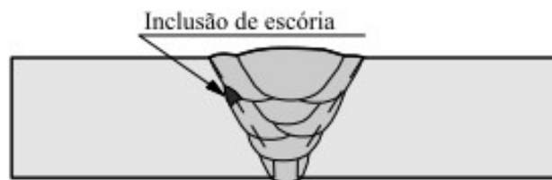
Figura 23 - Ilustração esquemática de inclusão de escória. [26]
