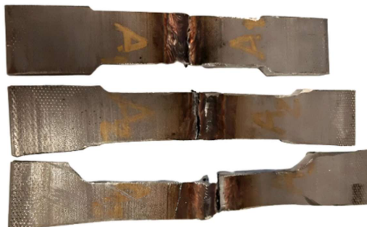
Figura 64 - Provetes A1, A2 e A3, após ensaio de tração.
