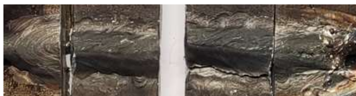
Figura 42 - Cordão de soldadura da Amostra D.
