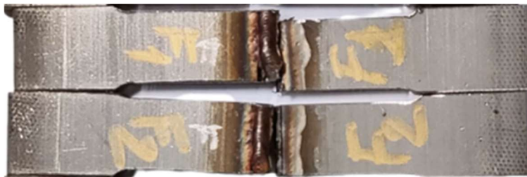
Figura 74 - Provetes F1 e F2, após ensaio de tração.
