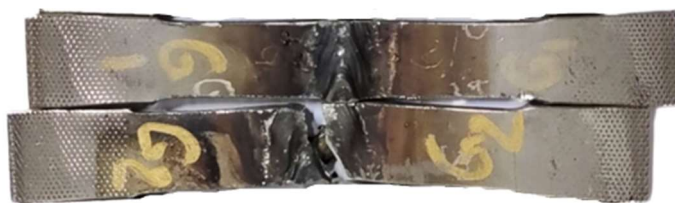
Figura 76 - Provetes G1 e G2 após ensaio de tração.
