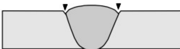
Figura 24 - Ilustração esquemática de mordeduras na última camada de um cordão de soldadura. [26]
