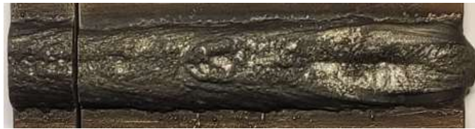
Figura 53 - Cordão de soldadura da Amostra J.
