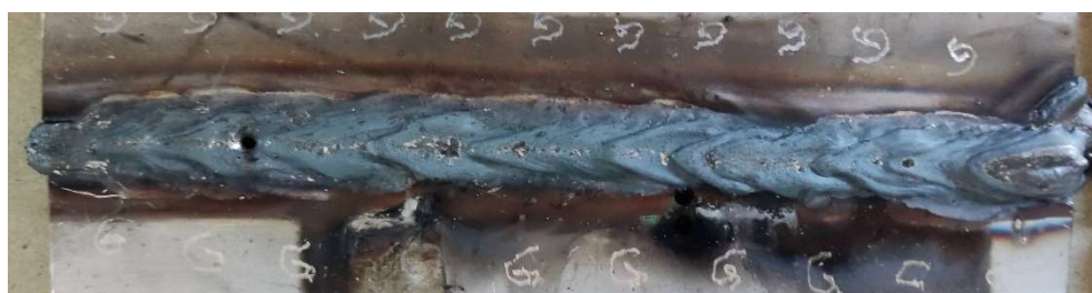
Figura 48 - Cordão de soldadura da Amostra G.
