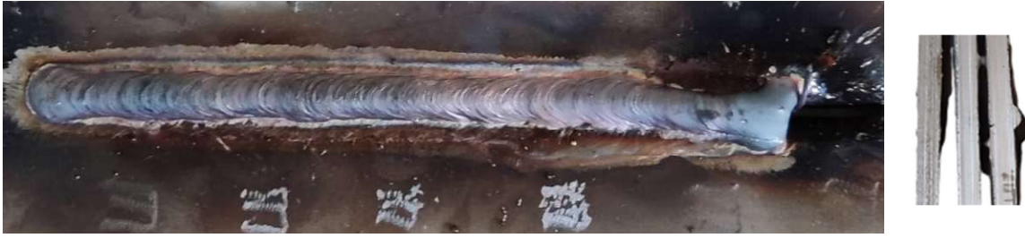
Figura 44 - Cordão de soldadura e secção transversal da amostra E.
