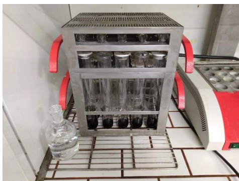
Figura 6.7. Digestão das amostras em ácido.
