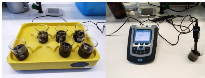
Figura 5.6. Amostras para determinação da condutividade e pH.
