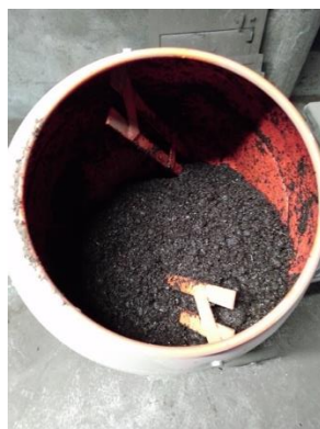
Figura 4.2. Homogeneização da mistura de resíduos.
