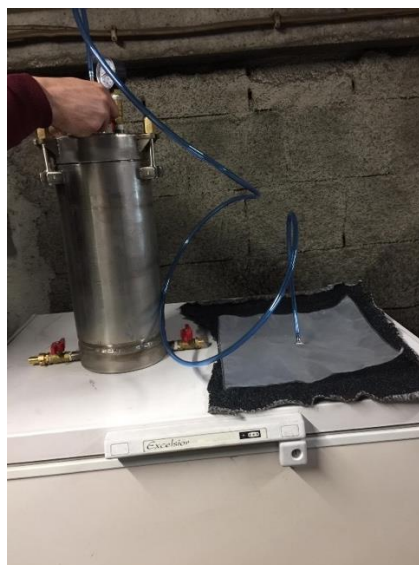
Figura 4.4. Coleta do biogás em reservatório de teflon.
