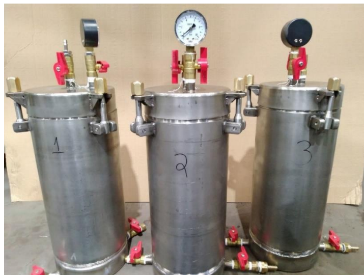
Figura 3.3. Protótipo final do digestor.
