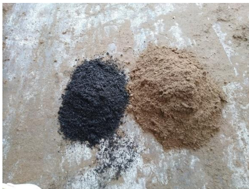
Figura 4.10. Mistura do digerido maturado com turfa.
