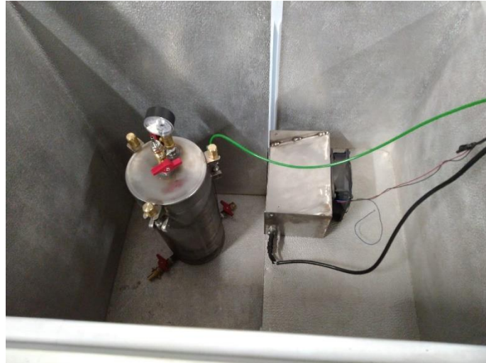
Figura 4.3. Montagem do teste preliminar com o digester, sonda temperatura (cabo verde) e resistência com ventilador, dentro da arca frigorífica).
