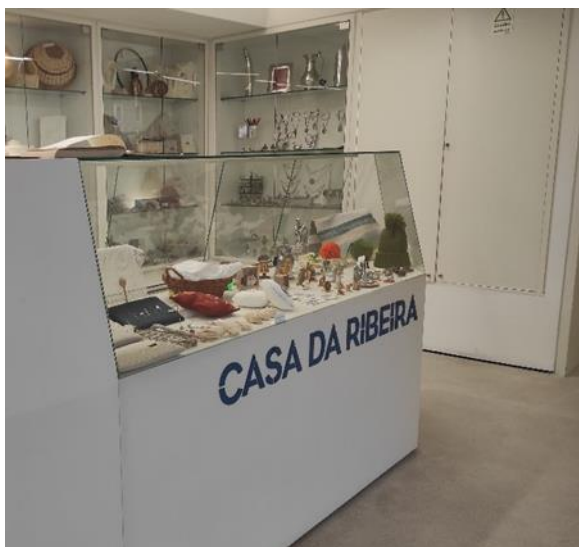
Figura 8 – Balcão de atendimento não rebaixado Fonte: Autora
