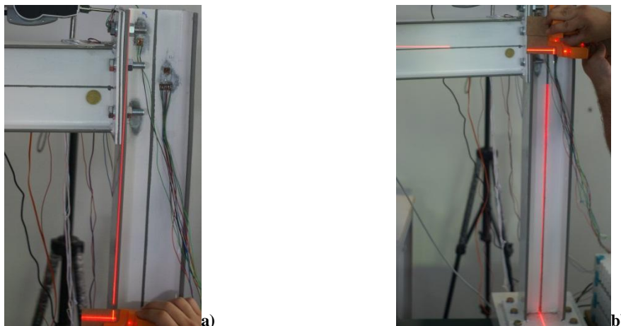
Figura 58 - Deformação plástica do modelo experimental depois de descarregado. a) Pormenor da deformação na região ligada; b) Deformação de todos os membros da ligação.
