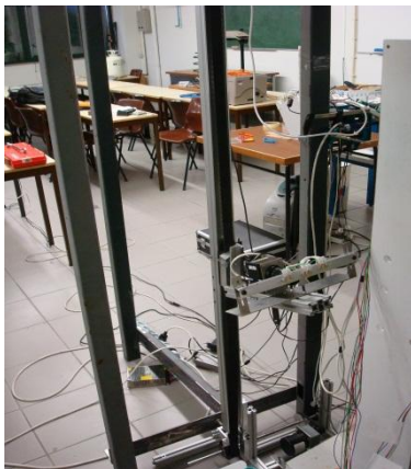
Figura 39 - Imagem dos equipamentos utilizados para o sistema de visão artificial. a) câmara e barra de LED's; b) Mecanismo de translação com a câmara; c) Computador de comando e de aquisição de imagem.
