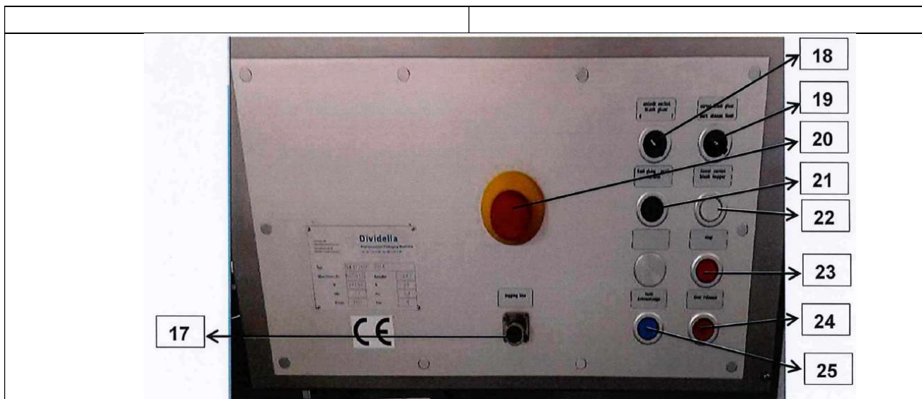
Figura 8 – Painel de comando parte superior do módulo de fusão do equipamento
