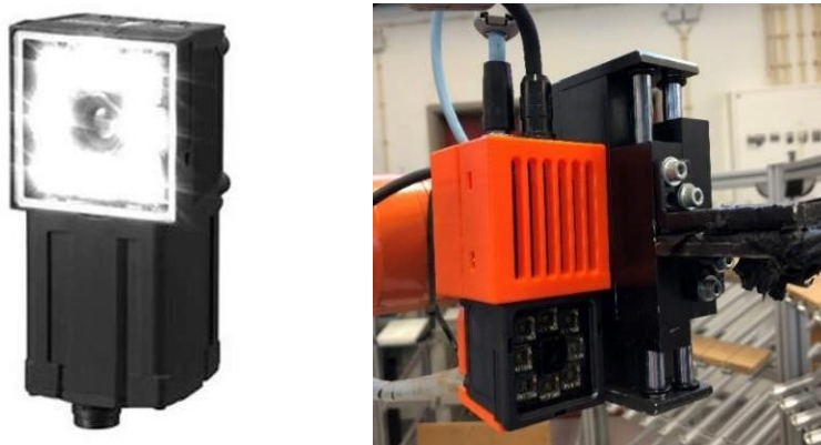
Figura 80: Câmara de visão FQ2 instalada na CFF.
