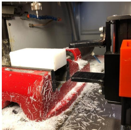
Figura 78: Descarregamento da fresadora CNC.
