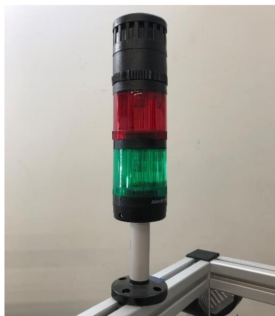
Figura 34: Baliza de sinalização luminosa e sonora.
