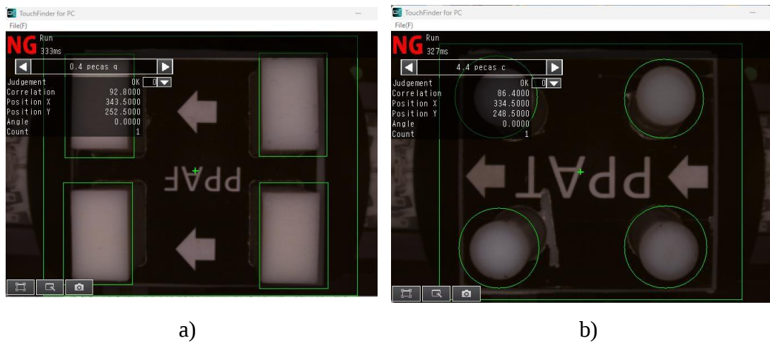
Figura C-4: Identificação de peças em palete de produtos acabados.
