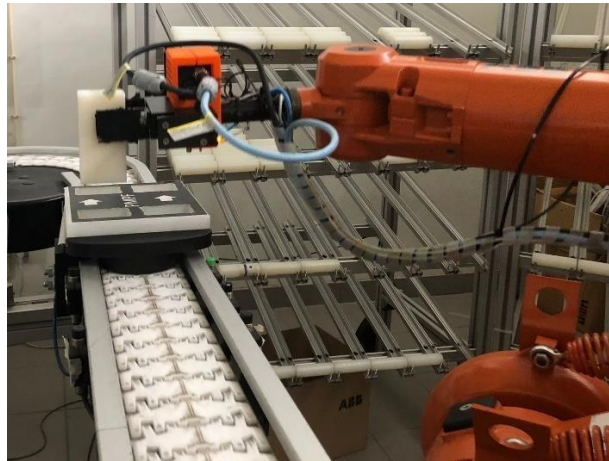
Figura 67: Correção do posicionamento das peças na paleta.
