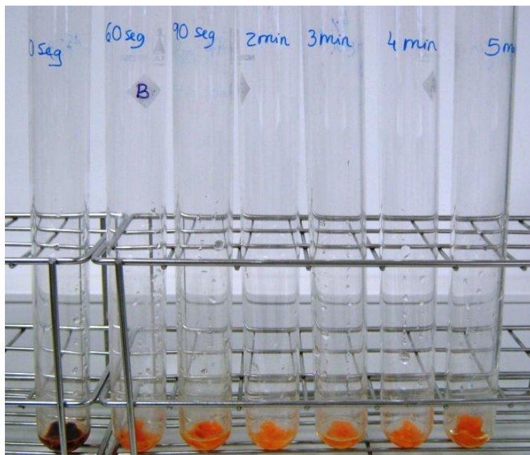
Figura 41: Teste da peroxidase para determinar o binómio tempo/temperatura do branqueamento da cenoura com infusão de chá branco (2g/500mL).
