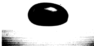
Figura 1: Vidro produzido a partir de resíduo da industria de beneficiamento de ferro
