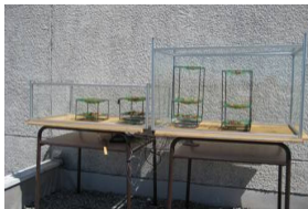
Figura 19. Estufas de secagem montadas na cobertura do edifício da ESTV.
