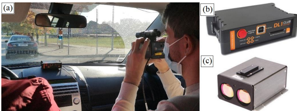
Figura 4.1 - Instrumentação: em (a) coleta em funcionamento, em (b) datalogger e em (c) LIDAR
