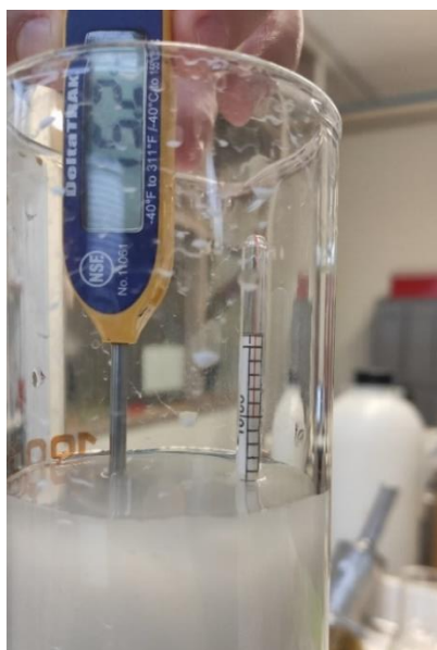
Figura 3-11: Aferição de densidade e temperatura da amostra PP Fonte: da Autora (2022)
