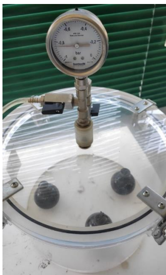
Figura 3-5: Provetes submetidos a bomba de vácuo Fonte: da Autora (2022)
