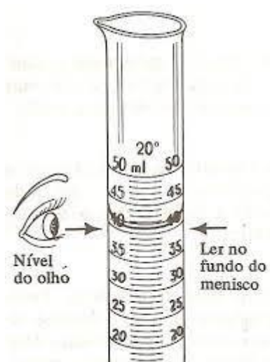
Figura 2-10: Correção da leitura do menisco Fonte: [33]
