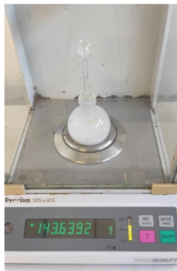
Figura 3-6: Aferição da massa do picnômetro com material PP Fonte: da Autora (2022)
