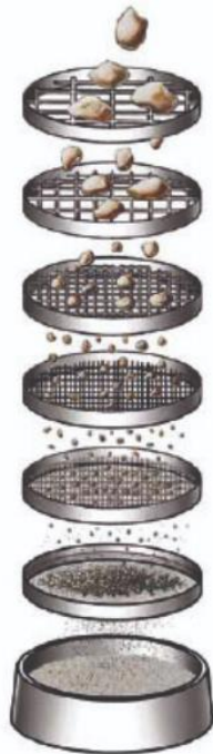
Figura 2-7: Ensaio de peneiração Fonte: [26]
