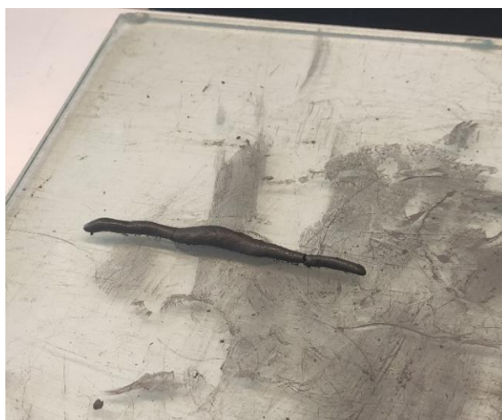
Figura 3-18: Rolamento da amostra RJ2 sobre a superfície de vidro Fonte: da Autora (2022)
