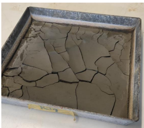
Figura 4-10: Retração de RJ1 durante secagem em estufa a 105 °C Fonte: da Autora (2022)
