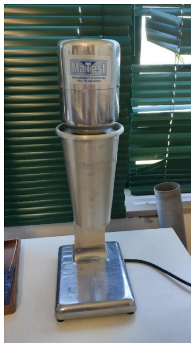
Figura 3-10: Aparelho dispersor automático Fonte: da Autora (2022)
