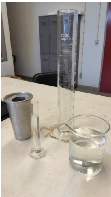
Figura 3-9: Materiais utilizados para o ensaio de sedimentação Fonte: da Autora (2022)
