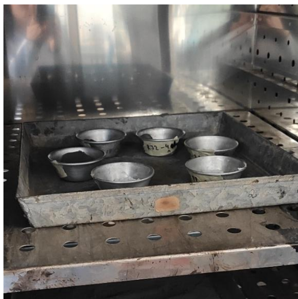
Figura 3-27: Secagem das amostras em estufa controlada Fonte: da Autora (2022)
