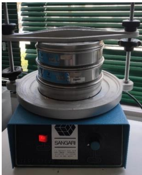
Figura 3-7: Agitador mecânico Fonte: da Autora (2022)
