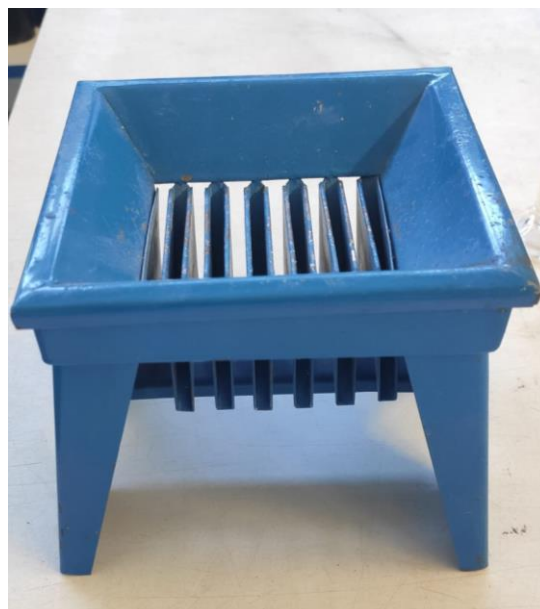
Figura 3-8: Equipamento Riffling ou esquarteramento Fonte: da Autora (2022)
