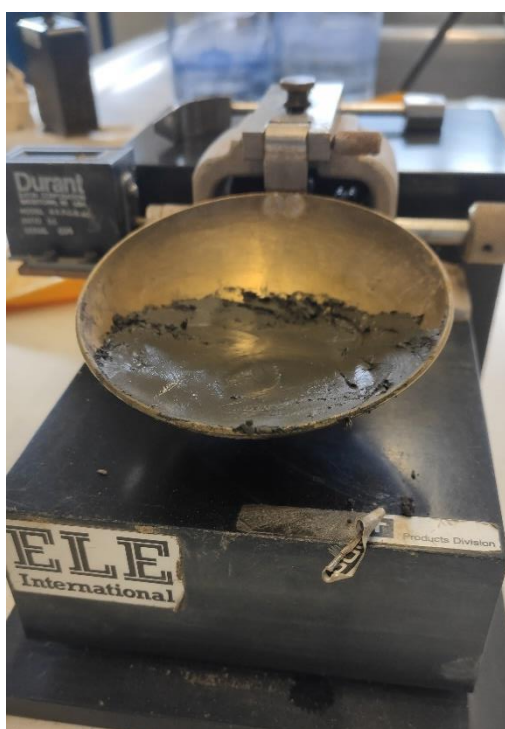
Figura 3-16: Preenchimento da concha de Casagrande com o material RJ1 Fonte: da Autora (2022)
