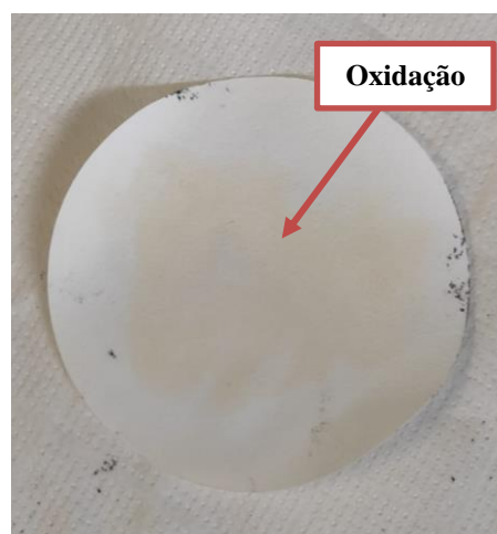
Figura 4-13: Papel filtro de rejeitos de mineração com marcas de oxidação Fonte: da Autora (2022)
