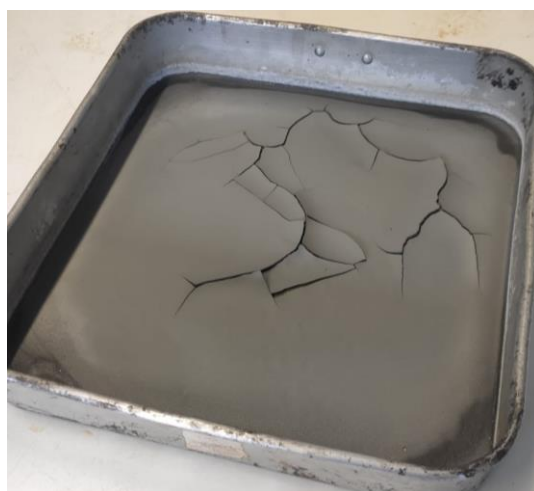
Figura 4-11: Retração de RJ2 durante secagem em estufa a 105 °C Fonte: da Autora (2022)
