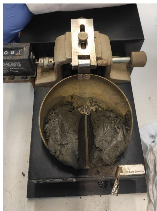
Figura 3-17: Ranhura no centro da concha sobre a pasta de RJ1 Fonte: da Autora (2022)
