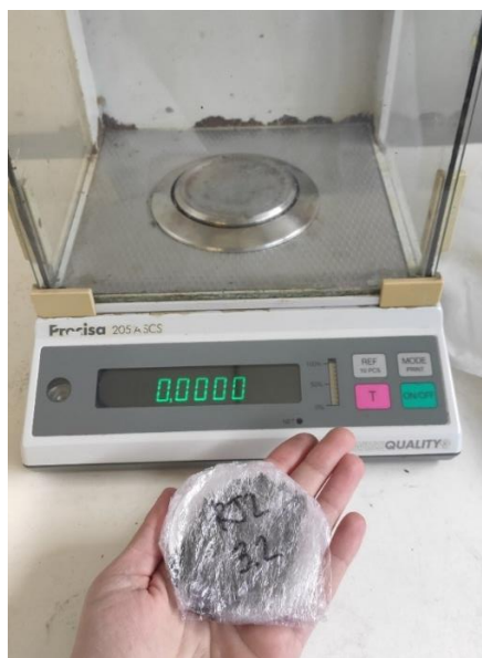
Figura 3-26: Aferição das massas em balança de ultra-precisão Fonte: da Autora (2022)
