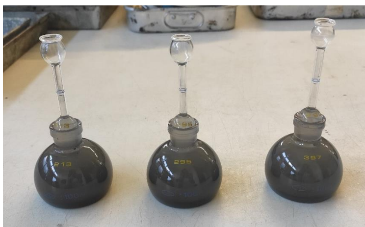
Figura 3-4: Densidade dos grãos com o material RJ2 Fonte: da Autora (2022)
