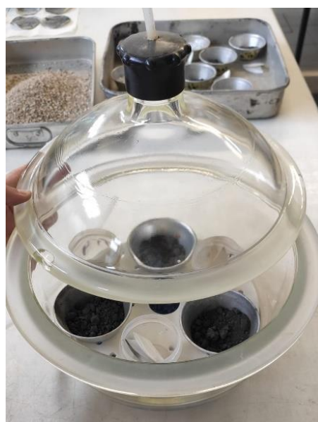
Figura 3-29: Amostras de RJ2 no dessecador Fonte: da Autora (2022)
