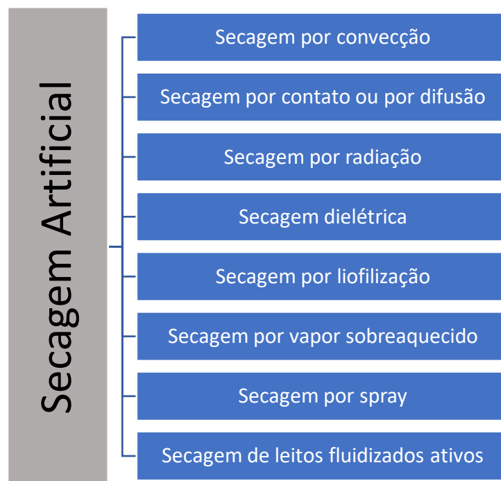
Figura 1 - Tipos de secagem artificial mais comuns (Fonte: Adaptado de Oliveira, 2009)
