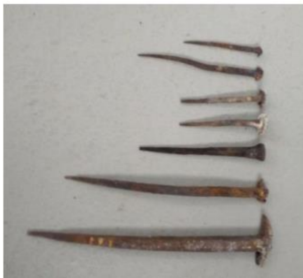
Figura 5 - Conectores metálicos (Fernandes, 2015)
