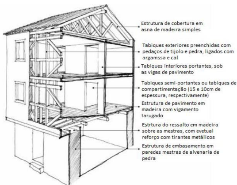
Figura 2 - Arquétipo estrutural de casa de resalto medieval (OASRS, 2016)
