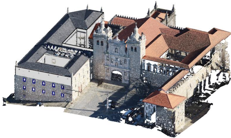
Figura 19: Colocação da nuvem de pontos no Revit com modelação da envolvente e vãos
