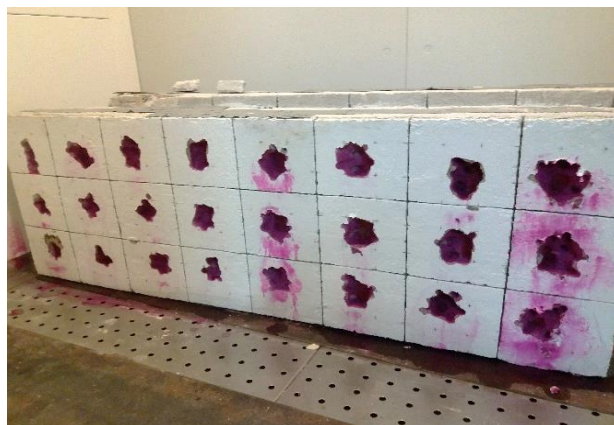
Figura III.12: Avaliação da carbonatação através da aspersão do indicador fenolftaleína in situ para o provete de ensaio P2.
