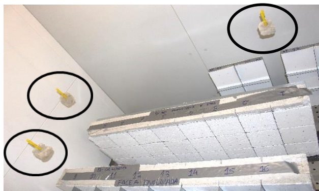
Figura III.5: Disposição dos provetes de ensaio e meios de controlo para validação das condições ambientais no interior da câmara climática.
