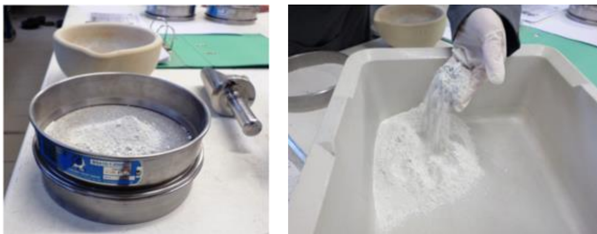
a) b) Figura 4-2: a) Peneiro com abertura em malha quadrada de 0,250 mm; b) Material passado no peneiro
