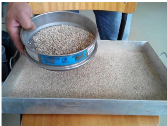
Figura 3-2: Retidos e passados no peneiro #2 mm
