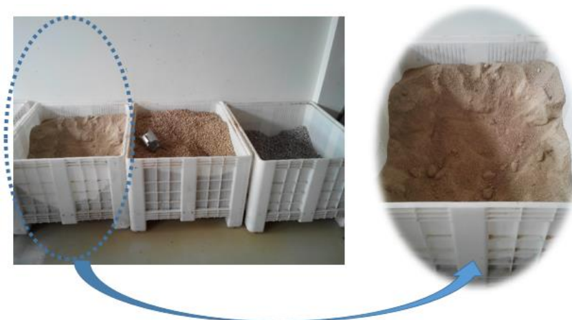
Figura 3-1: Areia disponível com dimensões compreendidas entre 0,063 e 4 mm
