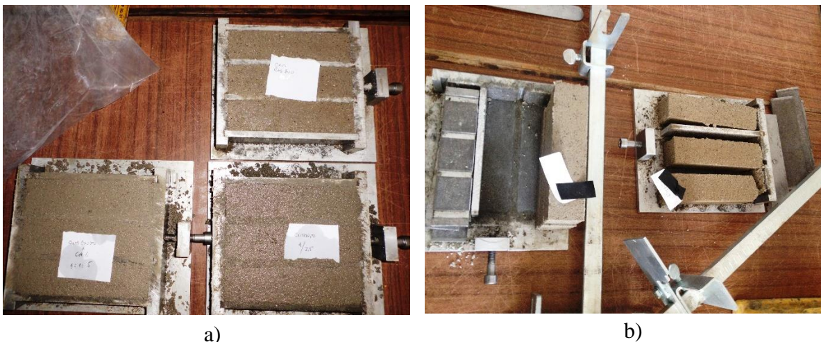
Figura 4-6: a) Identificação dos provetes; b) Desmoldagem dos provetes
