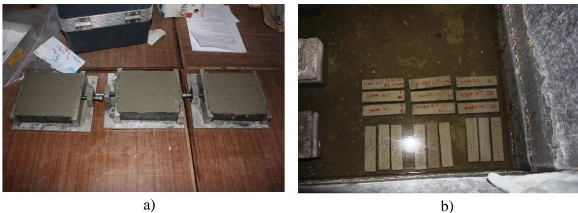
Figura 5-20: a) Três moldes para cada amassadura; b) Cura dos provetes submersos em água
