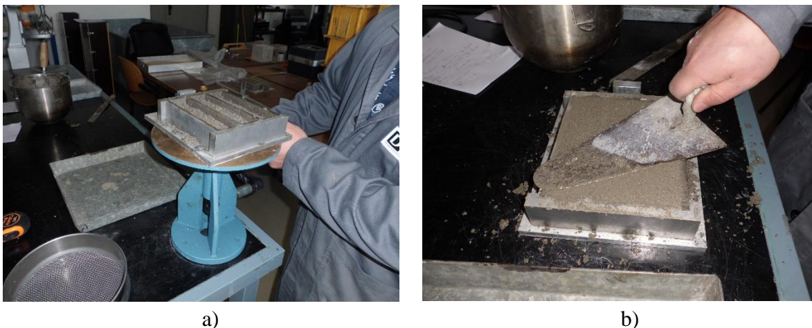
Figura 4-5: a) Compactação da primeira camada; b) Nivelamento da superfície
