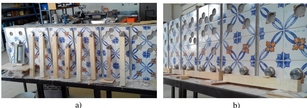
Figura 5-12: a) Apoios na colagem das pastilhas com pré-corte no azulejo; b) Apoios na colagem das pastilhas com pré-corte no azulejo + cimento-cola.
