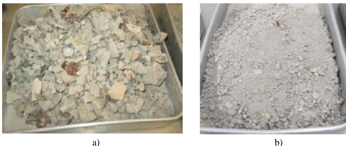
Figura 2-2: a) Material rejeitado pela peneiração (11,2 mm); b) Material resultante da peneiração (Cunha, 2013)
