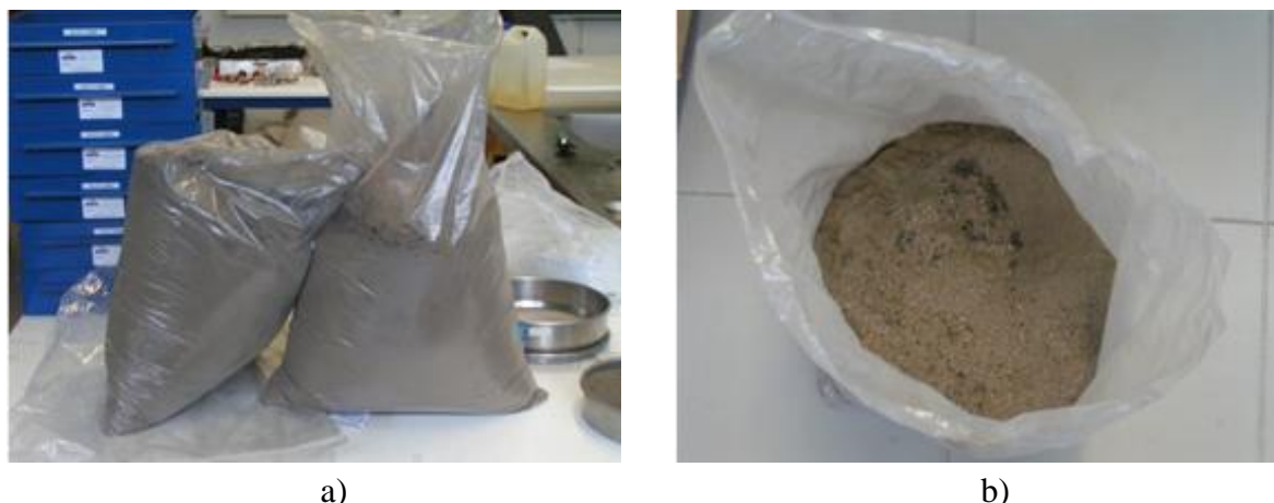
Figura 3-8: a) e b) Cinzas de biomassa provenientes da central termoelétrica
