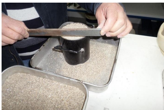
Figura 3-5: Nivelamento da superfície dos agregados
