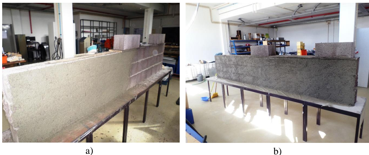
Figura 5-2: a) Projeção manual do chapisco; b) Aspetto final da parede com chapisco
