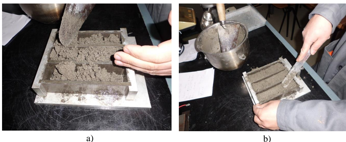
Figura 4-4: a) Enchimento da primeira camada dos provetes; b) Distribuição uniforme da argamassa
