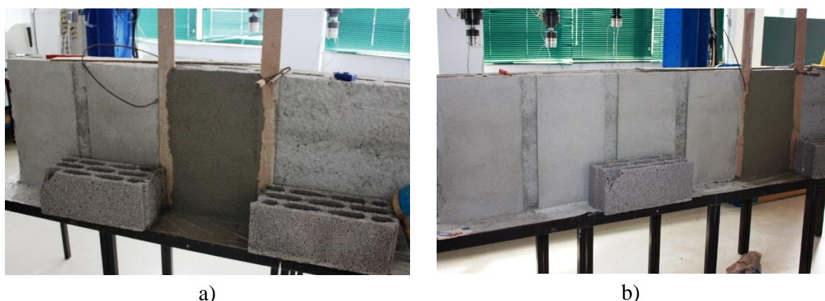
Figura 5-22: a) e b) Método de aplicação dos rebocos sobre a parede
