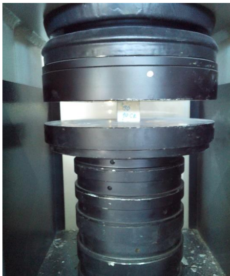
Figura 5-8: Prensa utilizada no ensaio de compressão dos cimentos-cola
