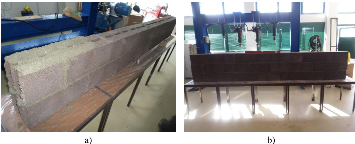
Figura 5-1: a) Assentamento da última fiada de blocos; b) Parede de alvenaria
