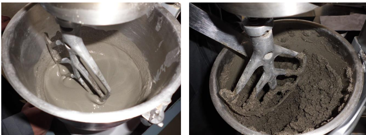
Figura 4-3: a) Mistura do ligante com água; b) Mistura com areia
