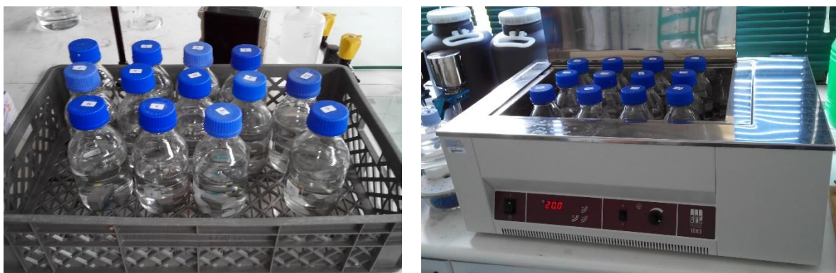
Figura 5-17: a) Identificação de cada amostra; b) Colocação das amostras no agitador mecânico
