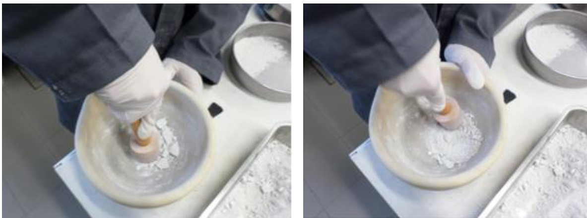
a) b) Figura 4-1: a) e b) Moagem das lamas de crómio
