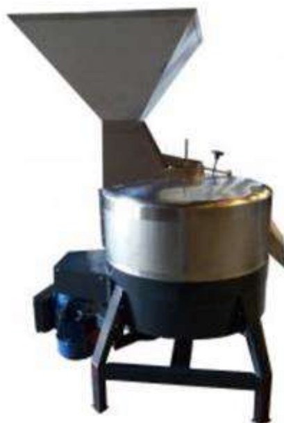
Figura 2 - Moinho de mó de pedra de granito utilizado para a moagem de castanha secada (empresa Secas e Boas, Celorico da Beira).
