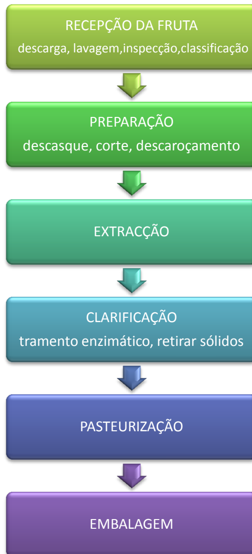
Figura 2. Processo de produção de sumos de fruta por extracção, (ANIRSF, 2007; Bates et al.2001) .
