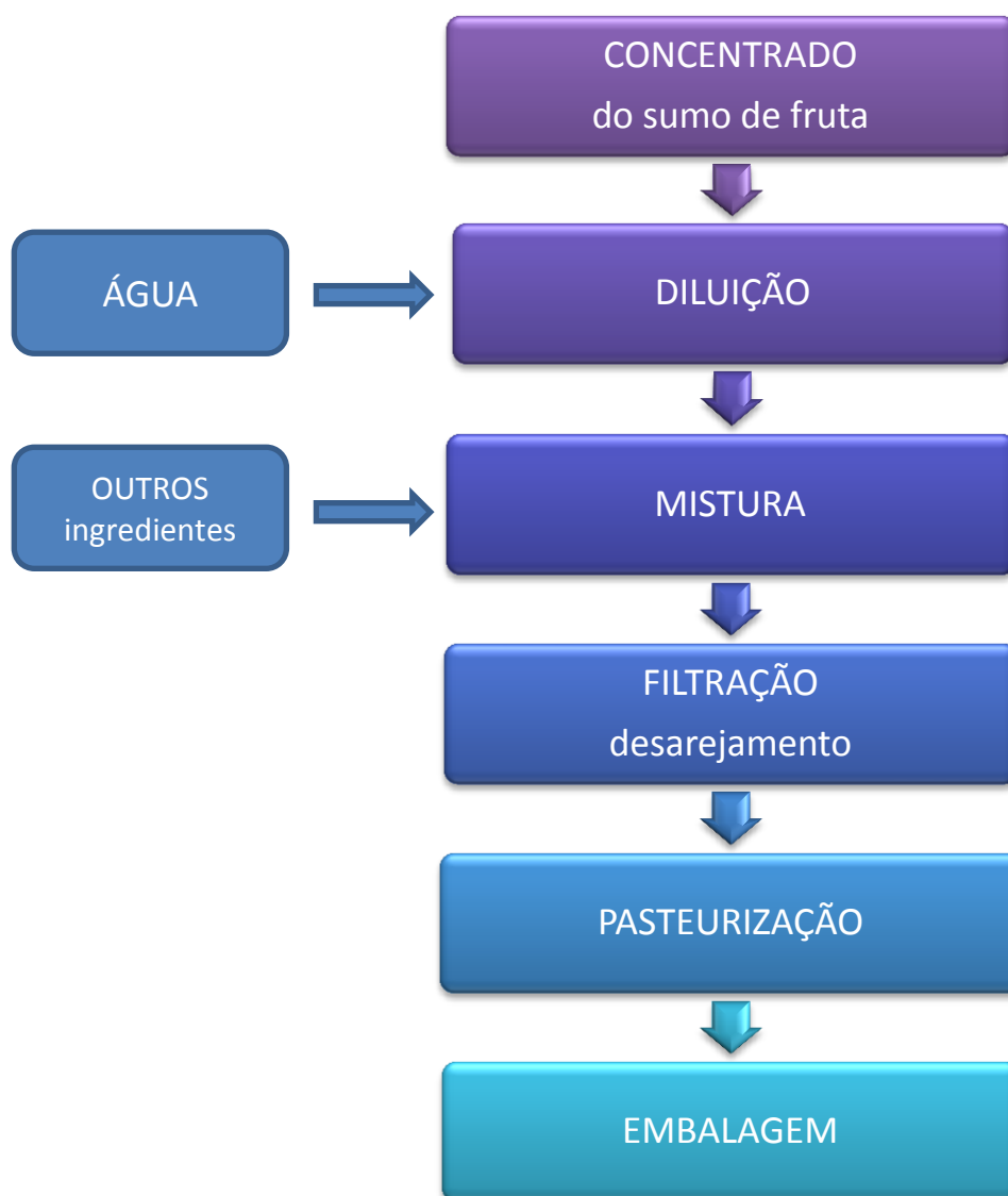
Figura 4. Processo de produção de sumos de fruta por reconstituição (diluição) de concentrados (ANIRSF, 2007; Bates et al., 2001).
