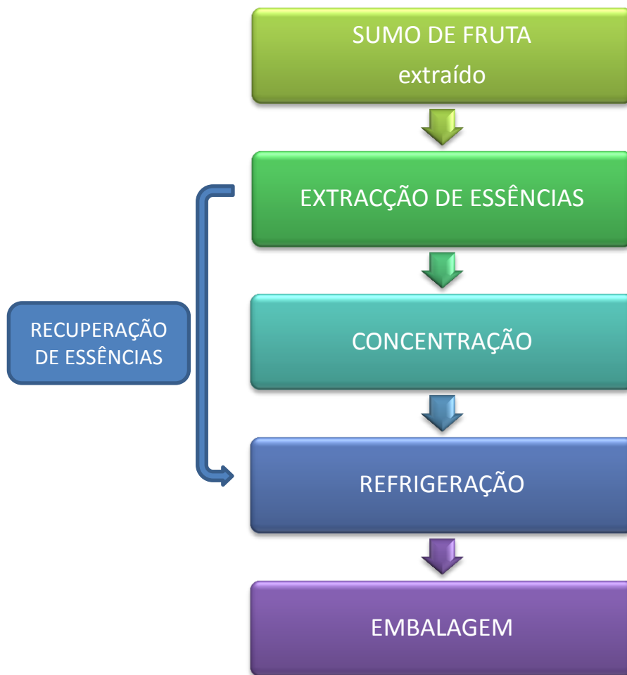
Figura 3. Processo de produção de concentrados de sumo de fruta, (ANIRSF, 2007; Bates et al., 2001).
