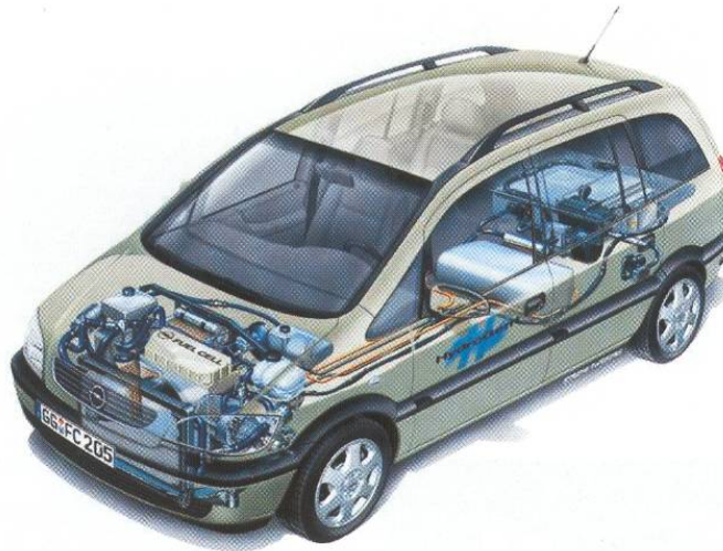
Figura 3.22 – Protótipo de células de combustível HydroGen 1 da General Motors/Opel em 2000. Com um tanque de 75 litros de hidrogénio líquido o carro têm uma autonomia de 400 Km. FONTE: [Gregor,03]
