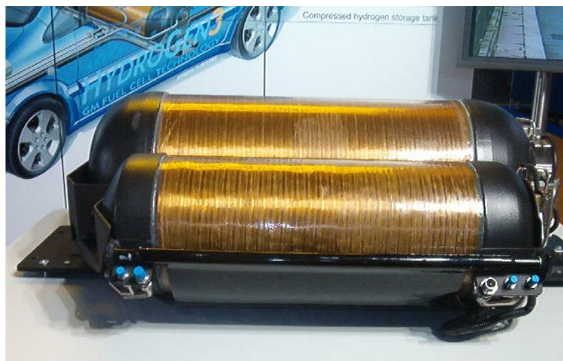
Figura 4.3 – Fotografia de dois depósitos feitos de material com compostos de carbono, de armazenamento do hidrogénio sobre a forma comprimida no automóvel “Hydrogen3 compressed 700” da GM, na Feira de Hannover em Abril de 2003. A pressão de serviço dos depósitos é de 700 bar, têm uma capacidade máxima de 77,4 litros (3,1 Kg) e um peso de 95 Kg, permitindo ao automóvel uma autonomia de 270 Km.
