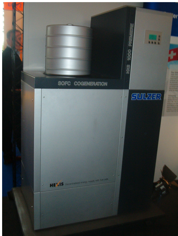
Figura 3.27 – Fotografia tirada em Abril de 2003 na Feira de Hannover. Sistema de cogeração de Pilha de Células de Combustível de Óxidos Sólidos “HXS 1000 PREMIERE” da Sulzer. Esta unidade destina-se a aplicações em casas unifamiliares, funcionando a gás natural. Segundo o fabricante têm uma potência eléctrica máxima de 1kW e uma térmica de 2,5 kW, sendo o rendimento para a parte eléctrica de 25 a 30 % e o global (eléctrico + térmico) de aproximadamente 85%.
