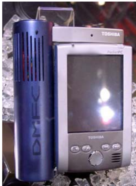
Figura 3.19 – Pilha alimentada com metanol líquido, com vista a fornecer energia ao televisor portátil. A Toshiba pretende comercializar este modelo em 2005 e segundo o fabricante a pilha a metanol fornecerá cinco a dez vezes mais energia do que uma bateria de lítio-íon.
