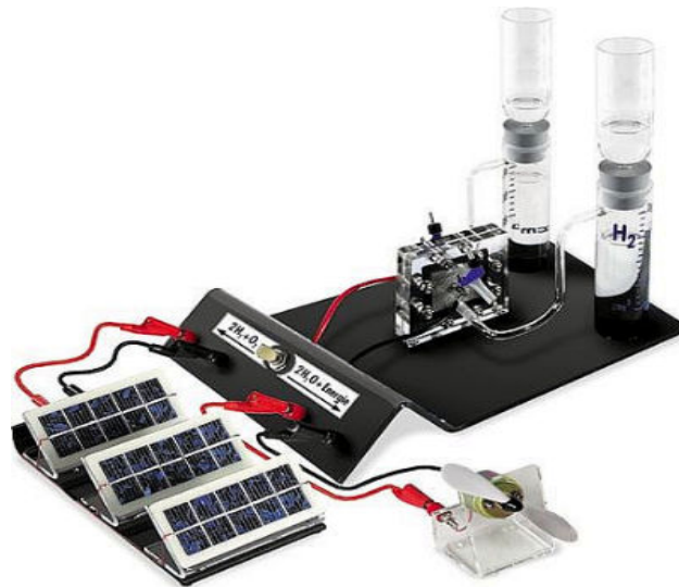
Figura 3.20 – Pilha de Células de Combustível Regenerativa (usa um sistema fotovoltaico para gerar H 2 por electrólise) de 1W, pesando 1,1 Kg e dimensões (c x l x h) : 210 x 330 x 286 mm FONTE: http://www.fuelcellstore.com/htec_pempower1_rfc_set.html
